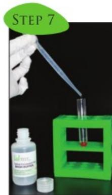
Con una pipeta grande coger Tampón de lavado y añadir 3ml dentro del tubo con la muestra.
