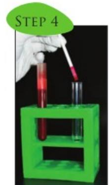
Mezclar el extremo de la tira colectora en el tubo que contiene Tampón 1.
