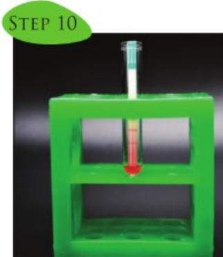
Coger una Tira XM e introducirlo en el tubo con la mezcla hasta que se complete la migración
