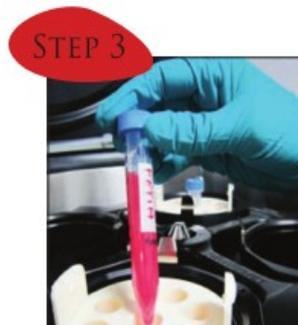
Centrifugar el tubo 3 min a 1000g o 2300 rpm.
